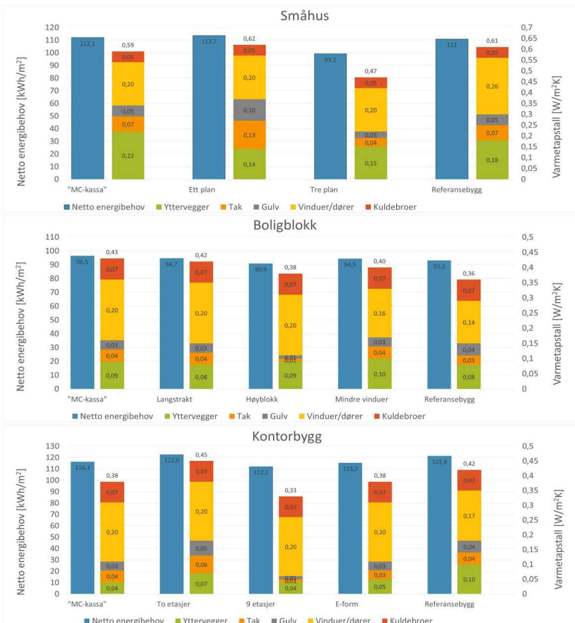
Figur 3: Varisjoner i bygningsrelatert varmetapstall og netto energibehov gitt ulike bygningsstørrelser og bygningsform, vist for småhus, boligblokk og kontorbygg.
